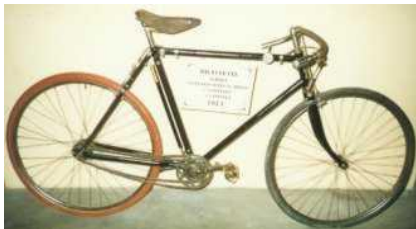
Vélo 6 vitesses = 3 dans le moyeu + 2 chaînes
