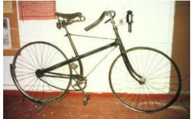
Bicyclette de 1888 à cadre en croix et transmission par chaîne
