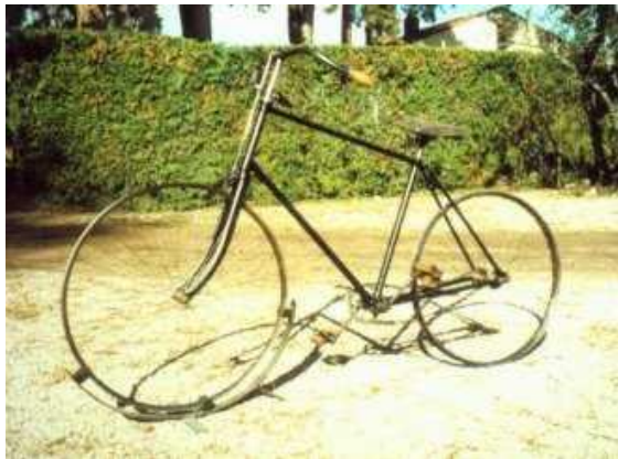
Bicyclette de 1890 à cadre classique et transmission par chaîne
